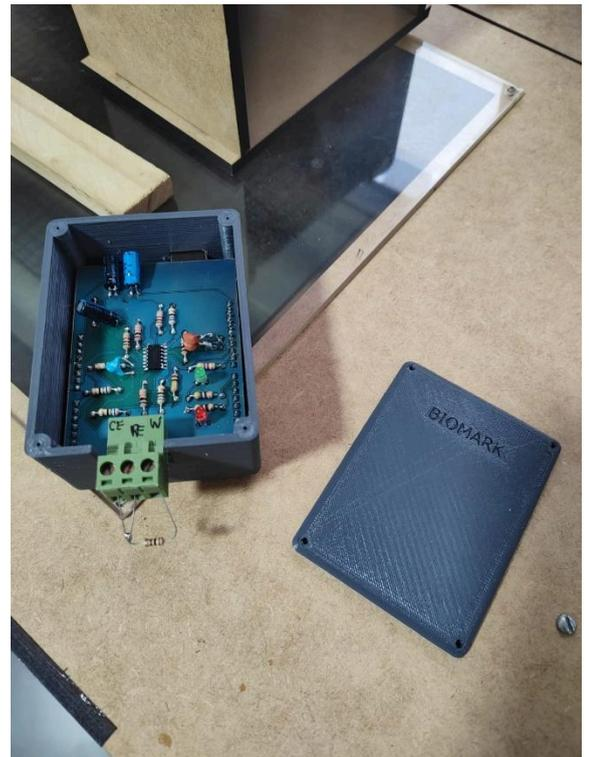
Logo após foram iniciados os testes práticos do potenciostato, através dos biomarcadores, utilizando uma solução laboratorial simples, assim, confirmando o funcionamento do protótipo através do processamento da informação recebida e da geração do gráfico de pulso.
