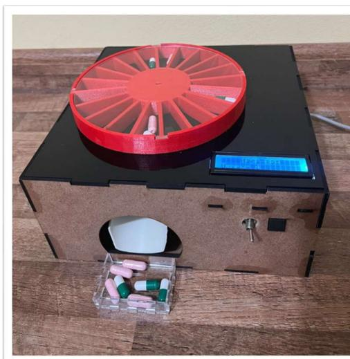
**Figura 2:** Estrutura completa do dispensador. A caixa foi construída em MDF, o carretel foi impresso em 3D e o escorregador foi fabricado em PVC. A tampa preta da caixa, o carretel e o recipiente onde o medicamento é depositado foram confeccionados em acrílico (fonte: próprias autoras).
