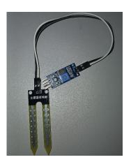
Figura 8: Módulo sensor de umidade do solo.
