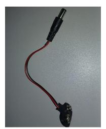
Figura 9: Plug de bateria 9V
