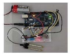
Figura 2: Circuito em funcionamento captando os dados e enviando para o app.
