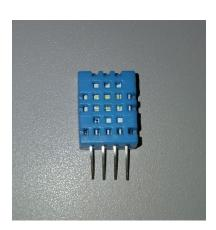
Figura 7: Sensor de temperatura/umidade do ar DHT-11.
