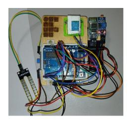
Desde os testes iniciais no simulador até a montagem física e programação do dispositivo, não foram detectados problemas significativos, o que valida a robustez do protótipo desenvolvido. Os testes práticos confirmaram que o medidor é capaz de realizar as funções de medição climática com precisão, transmitindo os dados diretamente para um dispositivo móvel sem a necessidade de conexão à internet, cumprindo assim um dos principais objetivos do projeto.
