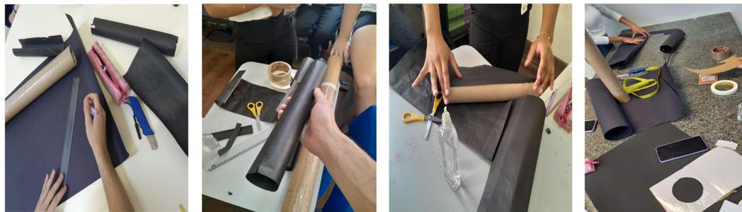
Para segurar a lente objetiva, foi construída com duas faixas de papelão encapadas com cartolina preta e duas tiras de EVA preto, um cilindro capaz de segurar a lente entre ele e o tubo maior. Já para a lente ocular foi necessário cortar o cabo da lupa e o encaixar no tubo menor.
