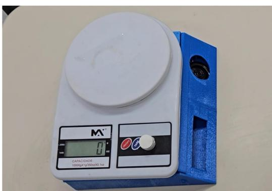
Figura 1. Protótipo da balança
