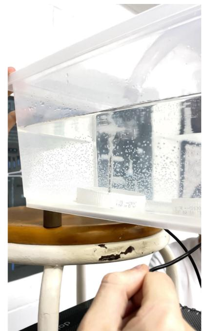
Imagem 3: Projeto em funcionamento com a produção de hidrogênio.
