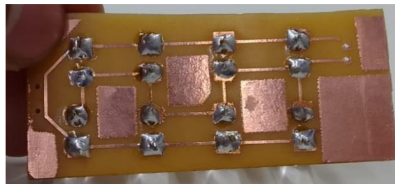
Figura 39 – Ilhas de solda
