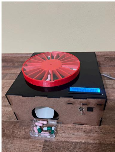
**Figura 1:** Estrutura completa: caixa, carretel, escorregador e tampa (Fonte: autoria própria).
