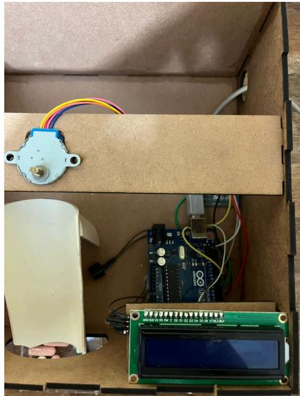
**Figura 3:** Parte interior do protótipo, com componentes eletrônicos: display, Arduino, Buzzer, Chaves e Motor (fonte: autoria própria).
