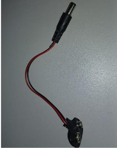
Figura 9: Plug de bateria 9V
