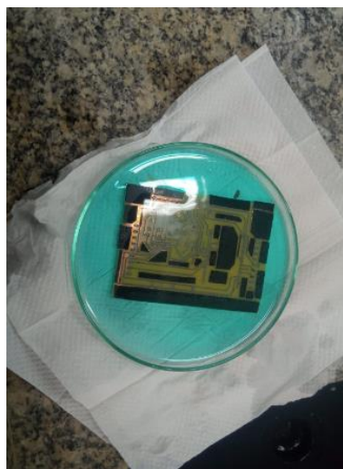
Figura 15 - Corrosão da placa
