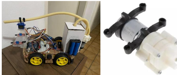
Figura 4 – Montagem do reservatório e mangueiras
