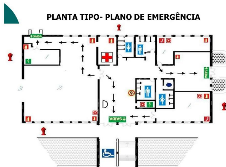
Figura 1 – Exemplo de Planta Baixa com as informações necessárias
