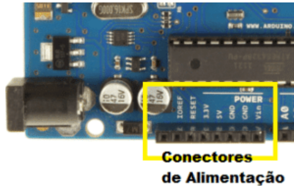
Figura 10 – Pinos de alimentação do Arduino UNO
