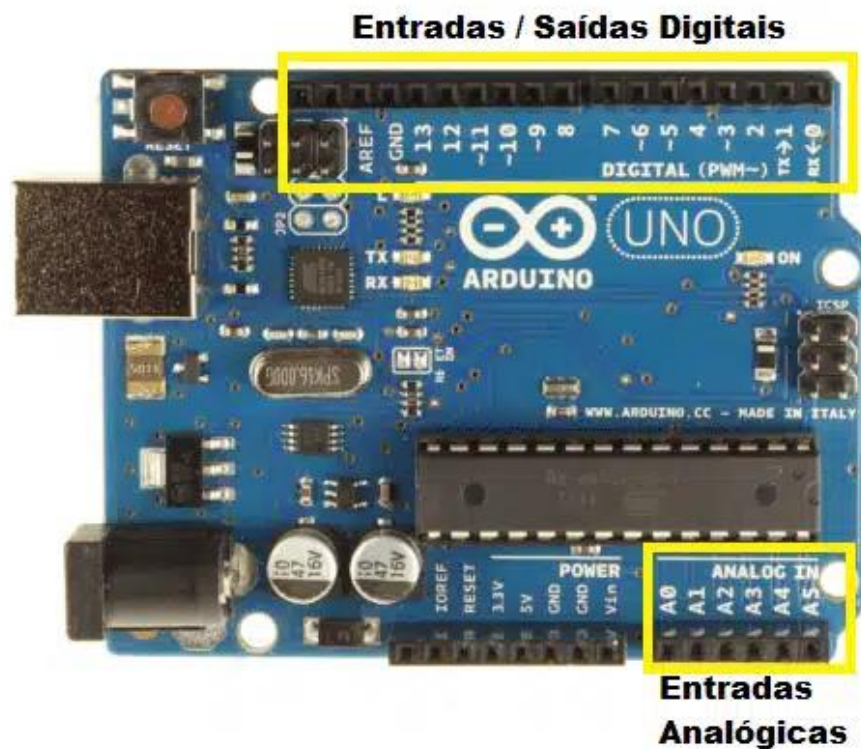
Figura 12 – Pinos de saída e entrada do Arduino UNO
