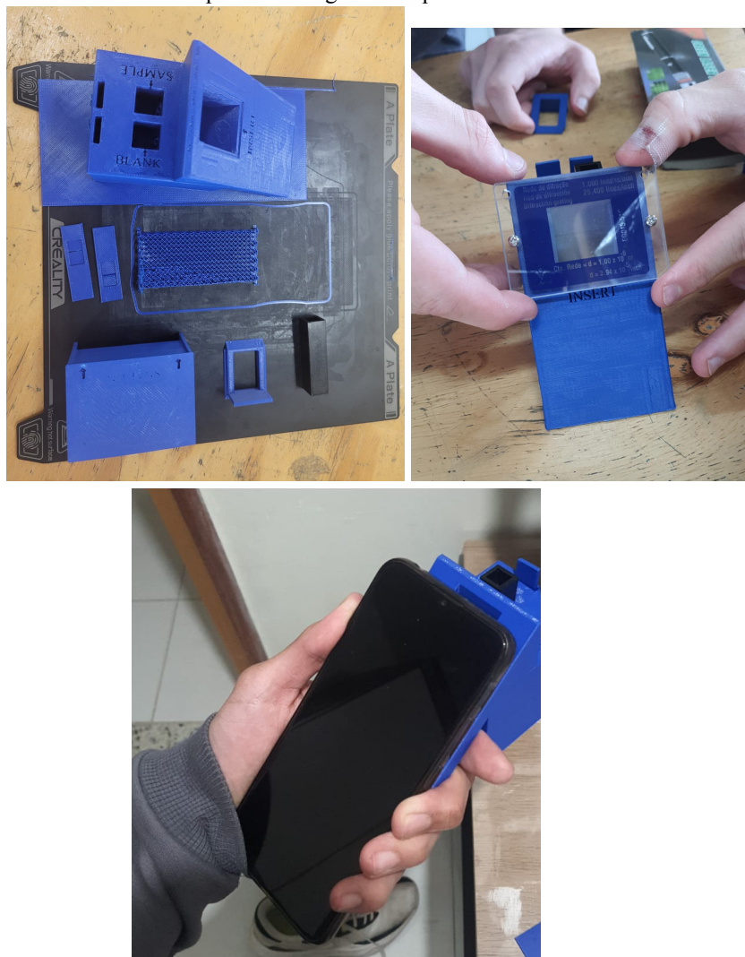
Figura 13- (A) Componentes individuais antes da montagem final. (B) Estrutura principal montada, evidenciando o compartimento para as cubetas e o caminho óptico. (C) Detalhe do encaixe do smartphone para a captura de imagem do espectro.
