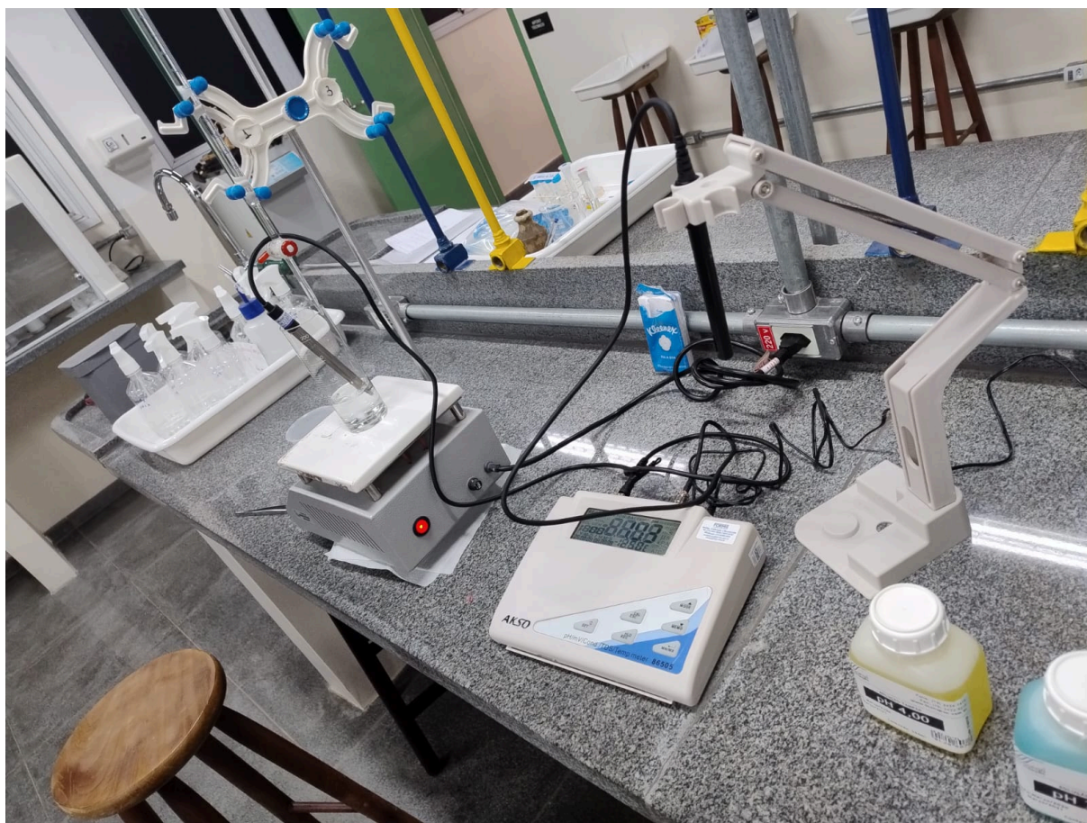
Figura 3: Bancada do laboratório durante a coleta de dados, exibindo o pHmetro, as soluções e as fitas.
