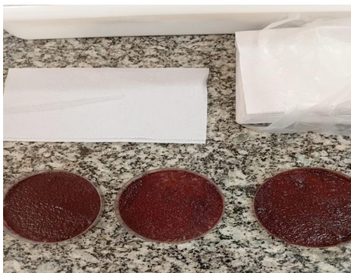
Figura A1. BF2 com 2% de amido, antes da secagem completa. Observa-se o filme ainda úmido e em processo de gelatinização.
