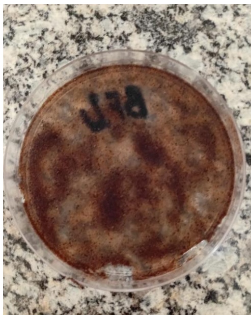
Figura A3. BF2 com 4% de amido após remoção de alguns pedaços para análise. Na parte restante, foi pingado NaOH, resultando em coloração verde em alguns pontos, indicando sensibilidade ao pH devido às antocianinas.
