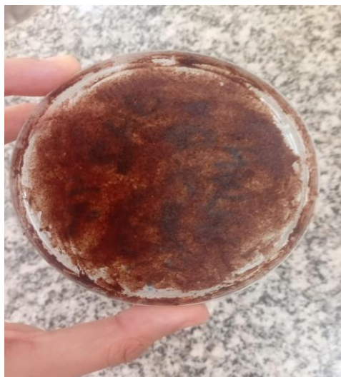
Figura A2. BF2 com 4% de amido, totalmente seca. Filme contínuo, porém espesso, evidenciando a necessidade de otimização da concentração de amido.
