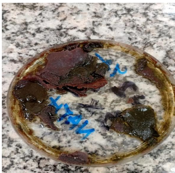
Figura A3. BF2 com 4% de amido após remoção de alguns pedaços para análise. Na parte restante, foi pingado NaOH, resultando em coloração verde em alguns pontos, indicando sensibilidade ao pH devido às antocianinas.
