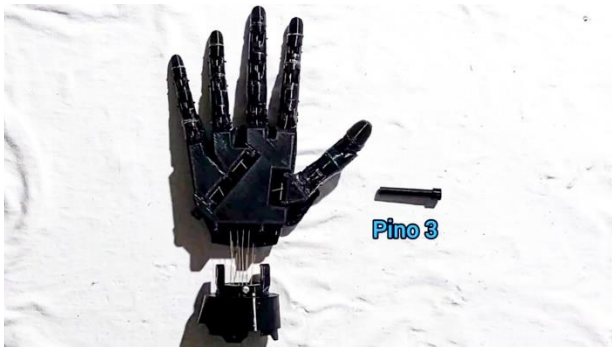
Figura 11: Encaixe da peça Pulso na Palma.
