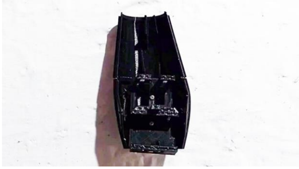
Figura 15: Peça Suporte Servos no Antebraço.
