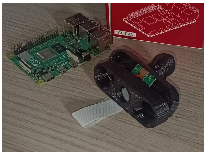
Figura 6: Câmera e Raspberry pi 4 .
