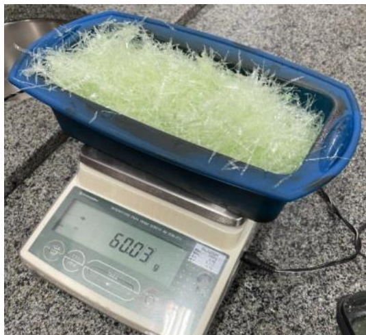
60g de plástico triturado para a produção da 2a placa experimental
