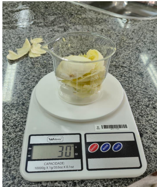
Figura 2: Béquer contendo 30 g de albedo de limão, etapa inicial da metodologia para produção do bioplástico.
