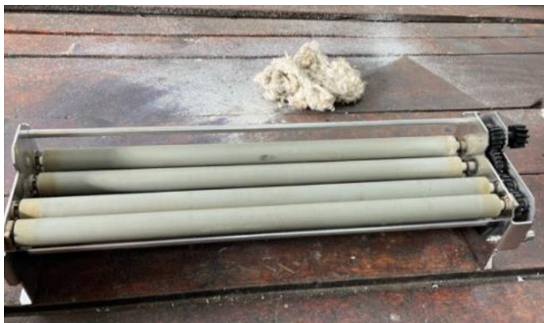
Imagem 4: Rolos, massa direcionada aos rolos para ficar com a espessura correta e menos encharcada
