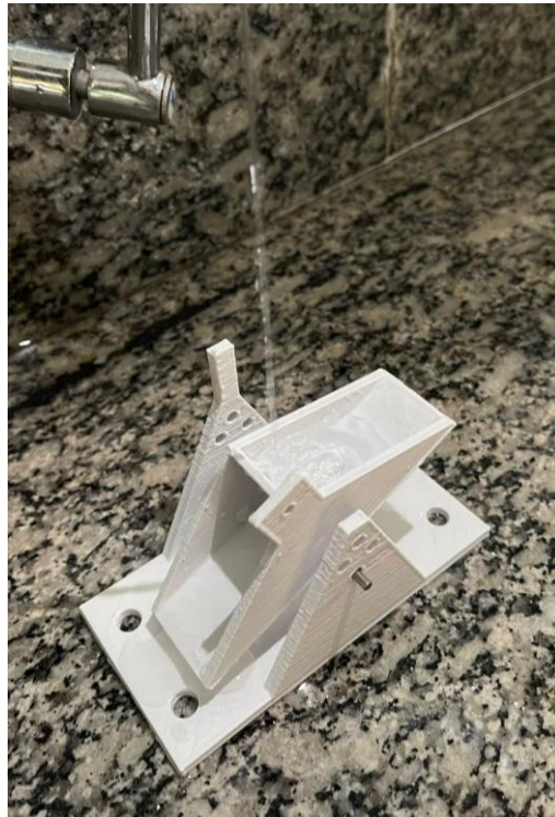
Figura 18 - Testes no pluviômetro
