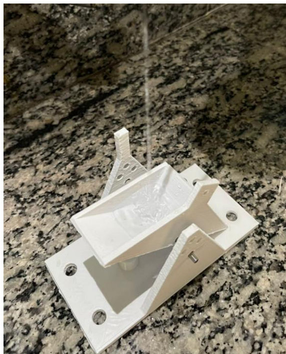
Figura 19 – Testes no pluviômetro e movimento da balança
