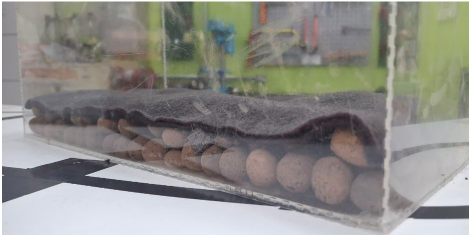
Figura 9 – Caixa de Acrílico com as argilas e a manta
