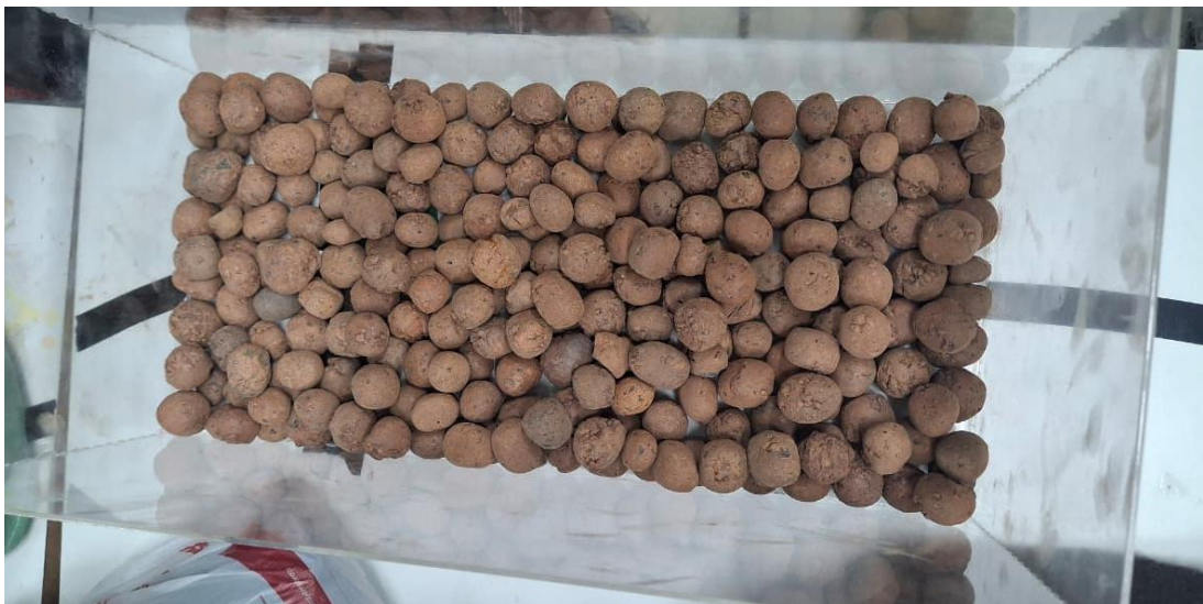
Figura 8 – Seleção de argilas e inserção destas na caixa de acrílico
