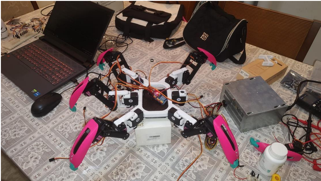
Figura 4: Pernas Semifinalizadas e Testes de Movimento
