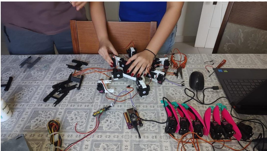
Figura 3: Montagem das Pernas do Protótipo
