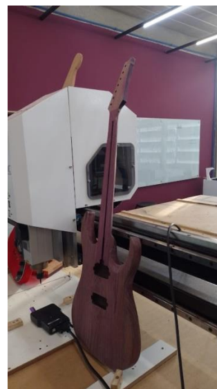
Figura 1: Corpo e braço encaixados pós-usinagem.
